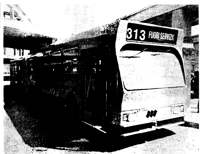
A sinistra il nuovo modello di autobus per trasporto suburbano, costruito dalla «Mauri & C.» di Desio, presentato ieri ai dirigenti della Tbsò. A destra, l'interno del nuovo modello di autobus snodato. I posti a sedere sono 58, mentre un altro centinaio di passeggeri possono trovare posto in piedi. Un'adeguata coibentazione ha consentito di ridurre la rumorosità. (Foto BEPPE BEDOLIS)
